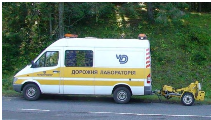
Рисунок 3.10 – Загальний вигляд УДВО-7 на базі дорожньої лабораторії ДП «Укрдіпродор» для визначення нерівності дорожнього покриття, модуля пружності, коефіцієнта зчеплення колеса автомобіля з покриттям
