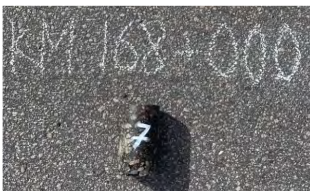
Рисунок Е.2 – Відібраний зразок-керна № 7, км 168+000 (лівий проїзд) км 165+000 (лівий проїзд)
