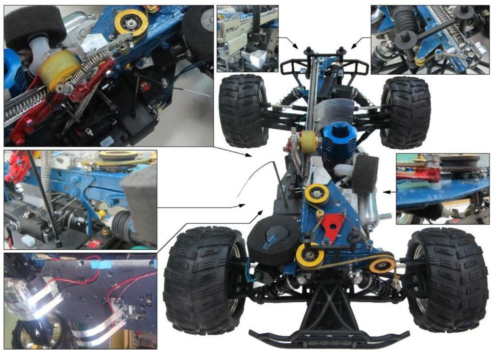
Рисунок 6 – Механізм активної підвіски фізичної моделі автомобіля
