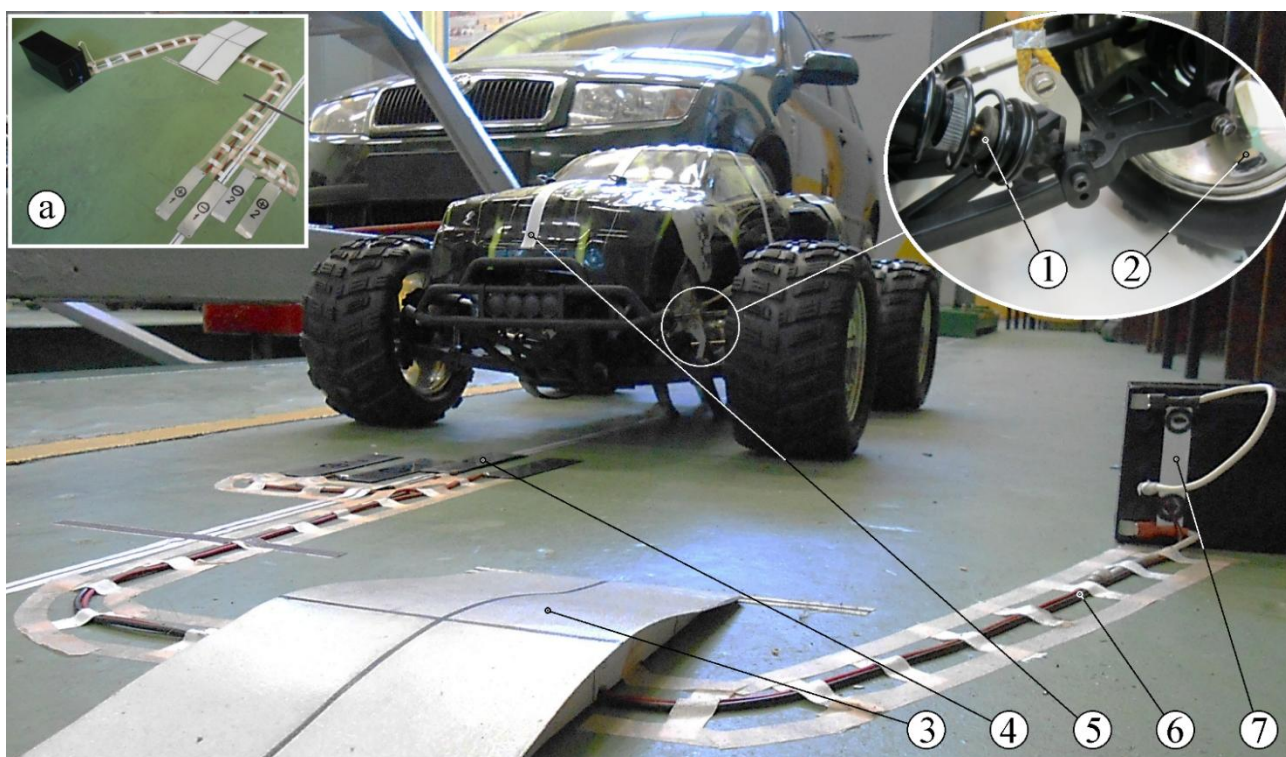
Рисунок 4.1 – Фізична модель автомобіля та дорожня нерівність, а також джерело енергії з контактною парою (а), що необхідні для роботи виконавчого пристрою активної підвіски
