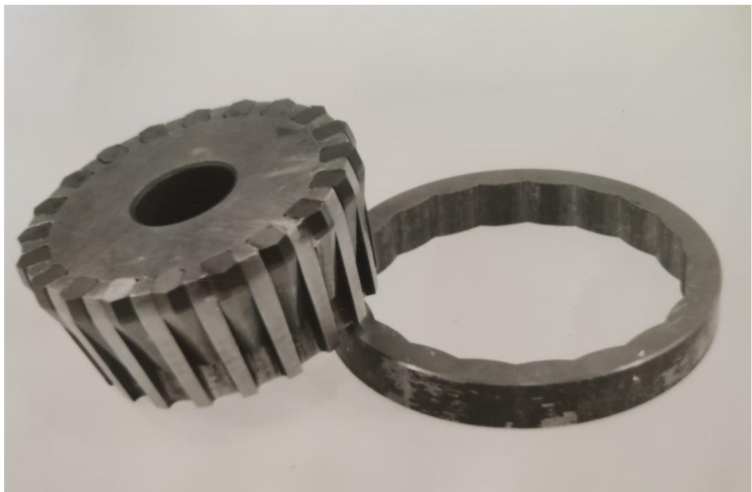
Рисунок 4.11 – Дослідний зразок інструмента (зліва) та фрагмент зразка після індентування (дуралюмін Д16, справа)
