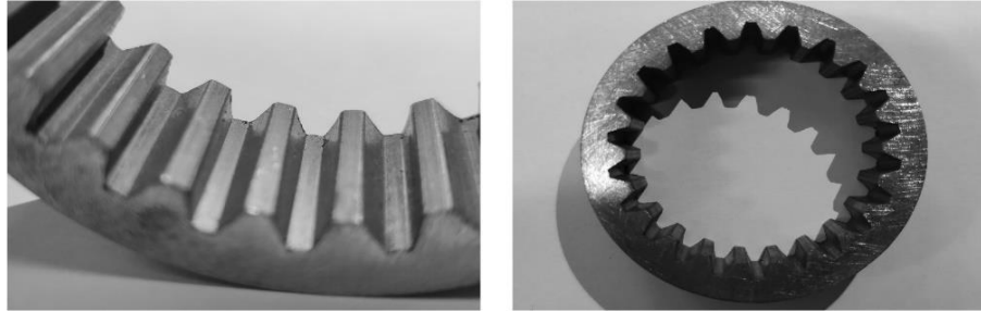
Рисунок 4.9 – Дослідний зразок колеса внутрішнього евольвентного зачеплення модулем m = 1,5 мм (сталь 38ХН3МА, редукування на багатозубій оправці)
