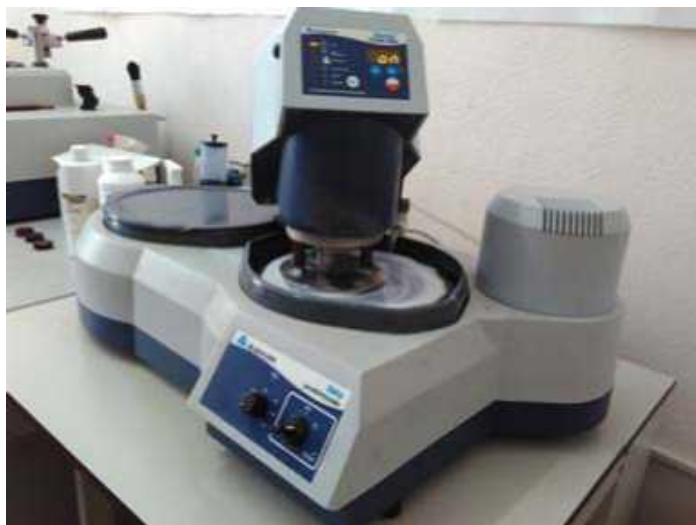
Рисунок 2.6 – Установка для отримання металографічних шліфів Beta Grinder-Polisher
