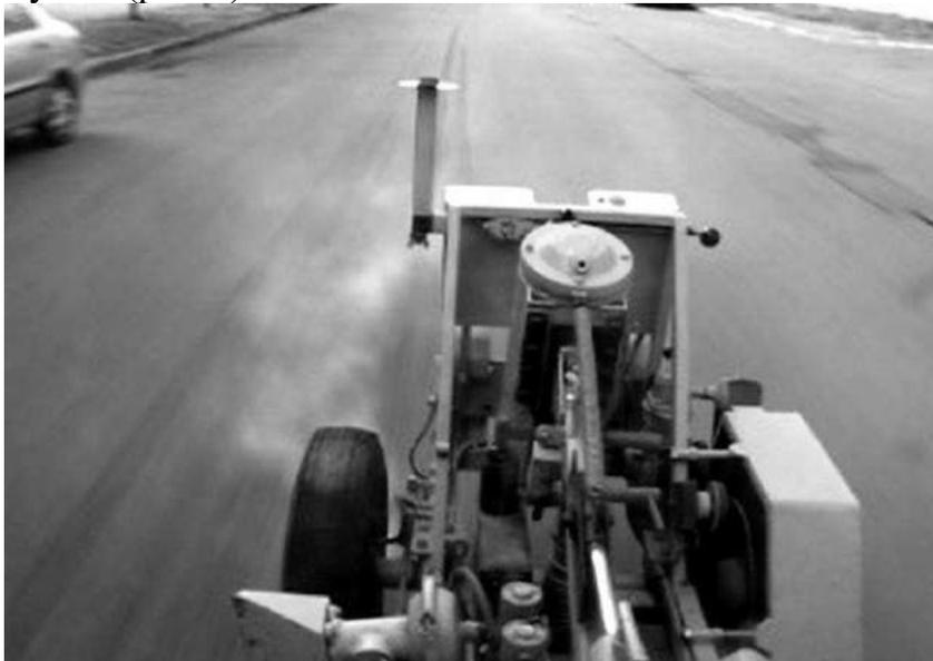
**Рисунок 6** – Експериментальне дослідження відхилення осі приладу від траєкторії руху
