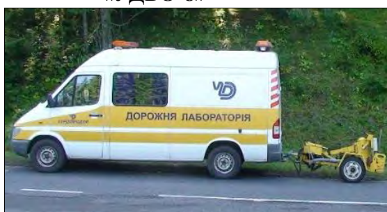
Рисунок 3.31 – Серійний ряд універсального дорожнього вимірювального обладнання «УДВО» та пересувні лабораторії
