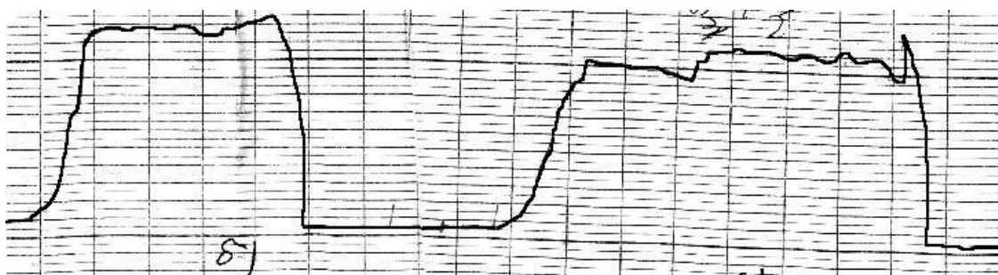
Рисунок 3.15 – Запис \Delta(t) діаграм при великій швидкості протягання стрічки самопису на зволоженому (а) і сухому (б) а/б покритті
