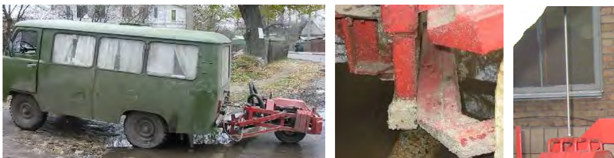
Рисунок 2.5 – Випадок критичного стану конструкції при транспортуванні приладу ПКРС (а, б) та щогла для спостерігання за причепом (в)
