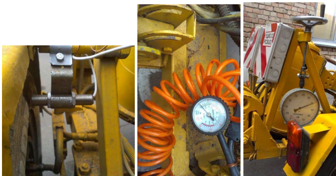
Рисунок 3.21 – а) Лічильник імпульсів (датчик переміщення), б) манометр (для прямого контролю тиску), в) Обладнання для калібрування
