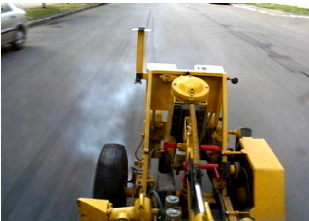
Рисунок 2.17 – Експериментальне дослідження відхилення осі приладу від траєкторії руху при блокуванні вимірювального колеса на швидкості 60 км/год від коефіцієнта зчеплення та часу
