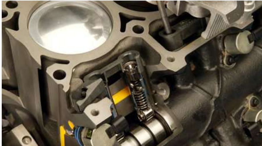
Рисунок 2.9 — Штовхач клапана системи MDS
