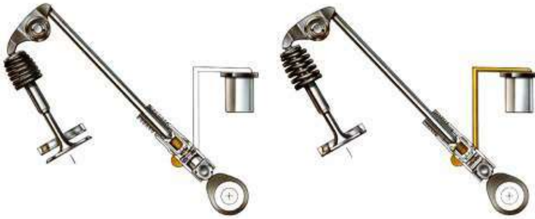
Рисунок 2.11 — Система відключення клапанів Active Fuel Management
