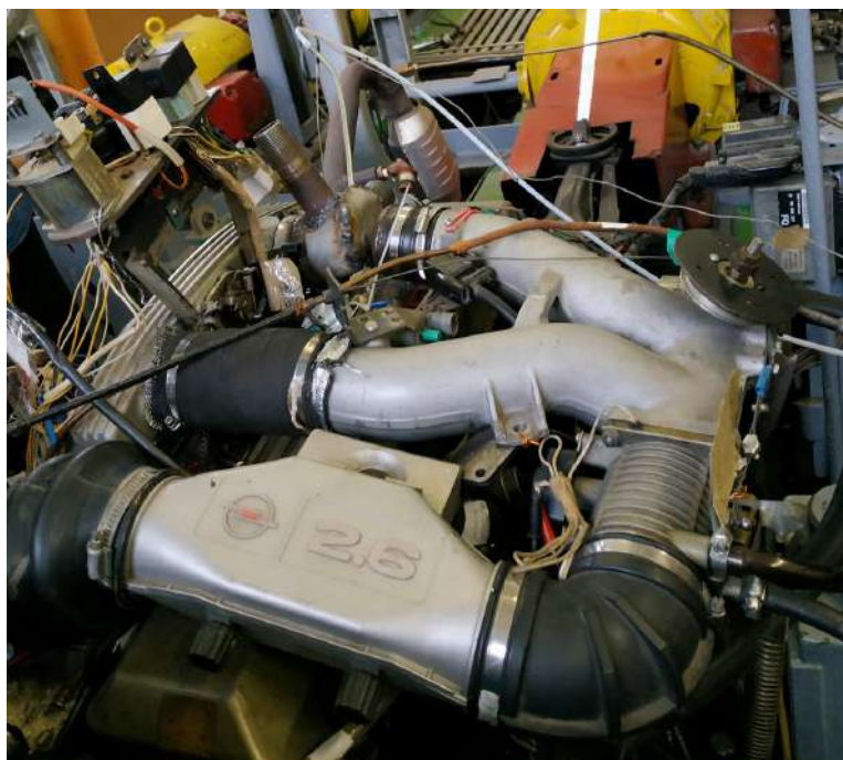
Рисунок 4.2 — Система впуску із внесеними змінами.
