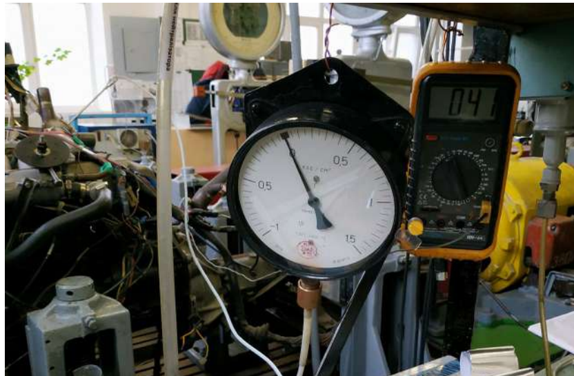
Рисунок 4.8 — Прилади для вимірювання температури повітря та розрідження на впуску у відключену групу циліндрів
