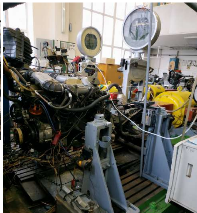
Рисунок 4.4 — Двигун 6Ч9.5/6.98 на гальмівному стенді:
