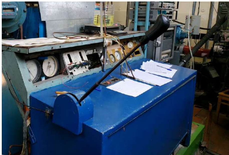
Рисунок 4.5 — Пульт керування двигуном 6Ч9.5/6.98.
