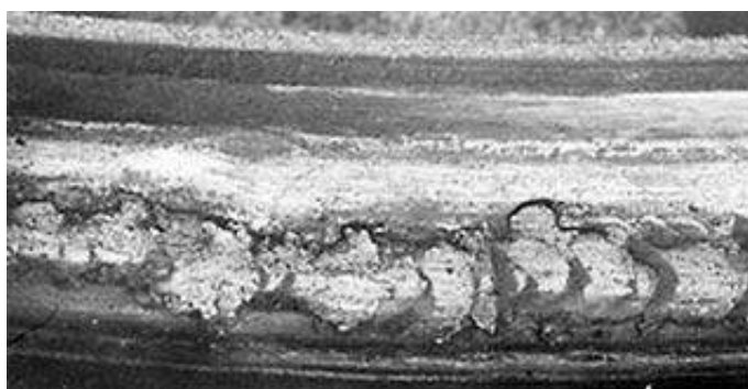
Рисунок 1.25- Навари на поверхні катання колеса
