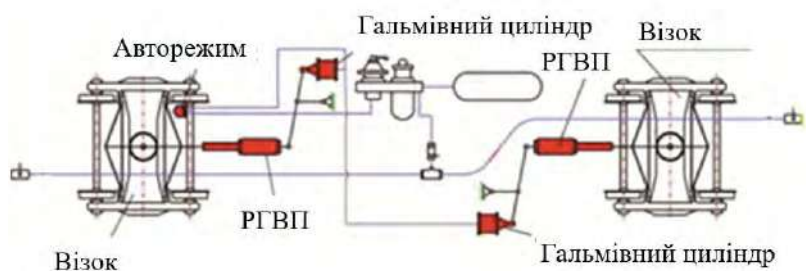
Рисунок 1.17 – Гальмівна система вантажного вагона з по візковим гальмуванням
