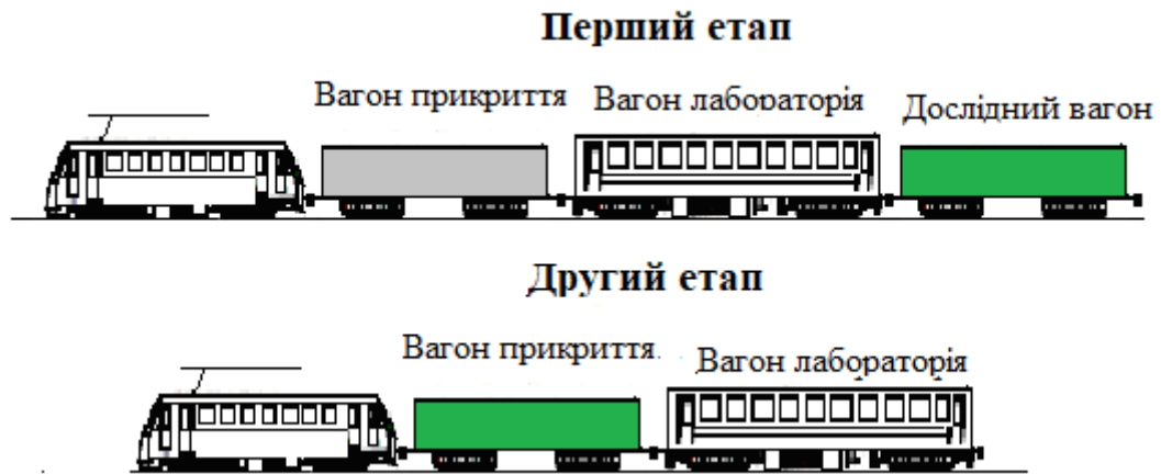
Рисунок 5.1- Метод послідовних гальмування
