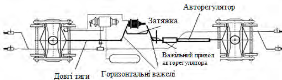
Рисунок 1.7 – Механічна частина гальмівної системи вантажного вагона
