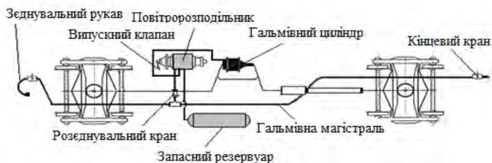
Рисунок 1.6 – Пневматична частина гальмівної системи вантажного вагона
