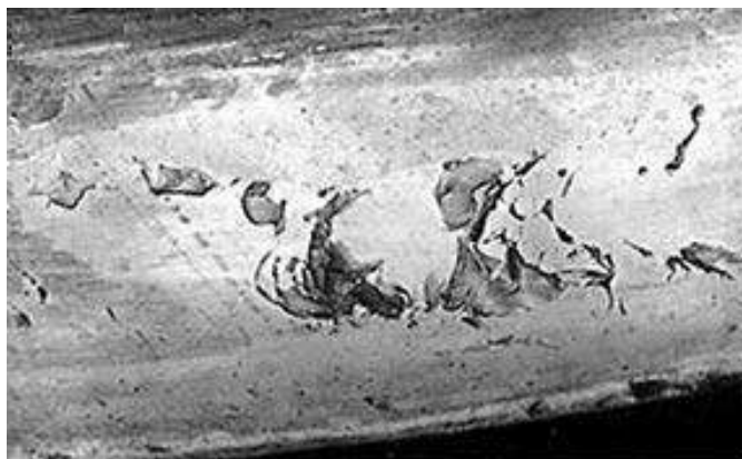
Рисунок 1.24 - Вищербини на поверхні катання колеса
