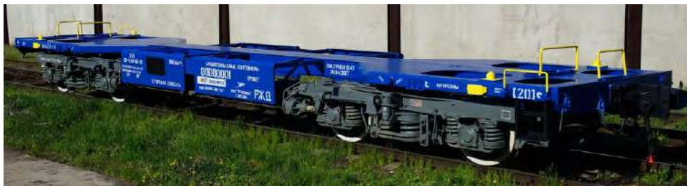
Рисунок 1.4 Вагон-платформа моделі 13-6954 (з візками моделі 18-6960)
