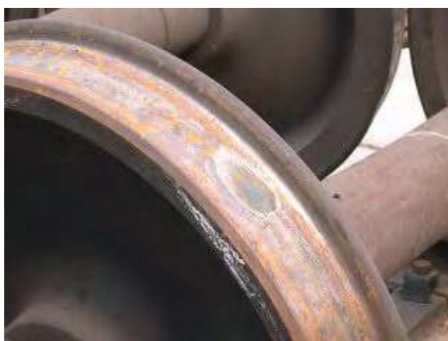
Рисунок 1.26 - Повзуни на поверхні катання колеса
