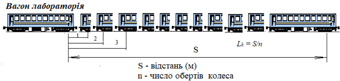
Рисунок 5.7- Методика визначення фактичної довжини кола колеса
