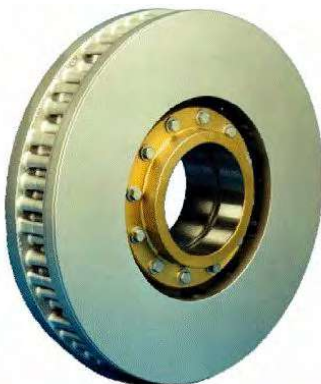
Рисунок 1.34 - Гальмівний диск, що встановлюється на осі колісної пари
