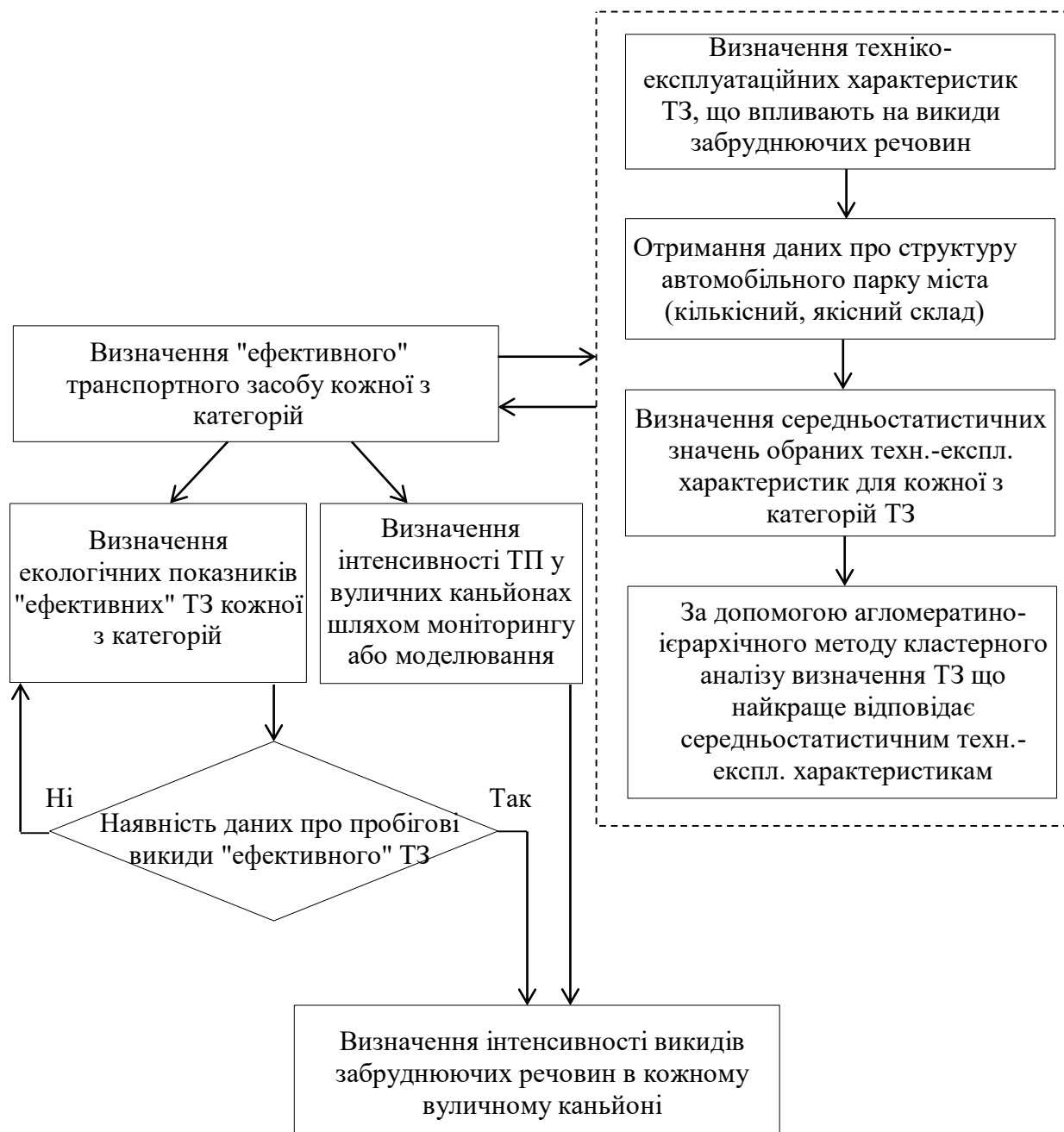
Рисунок 4.15 – Алгоритм визначення інтенсивності викидів забруднюючих речовин ТП
