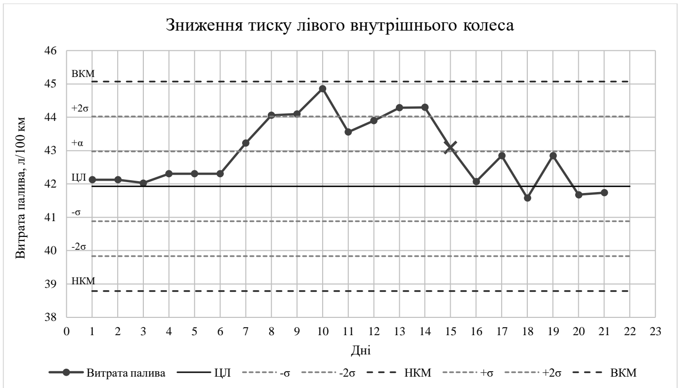
Рисунок 7 – Контрольна карта Шухарта витрати палива в л/100 км при спусканні лівого внутрішнього колеса
