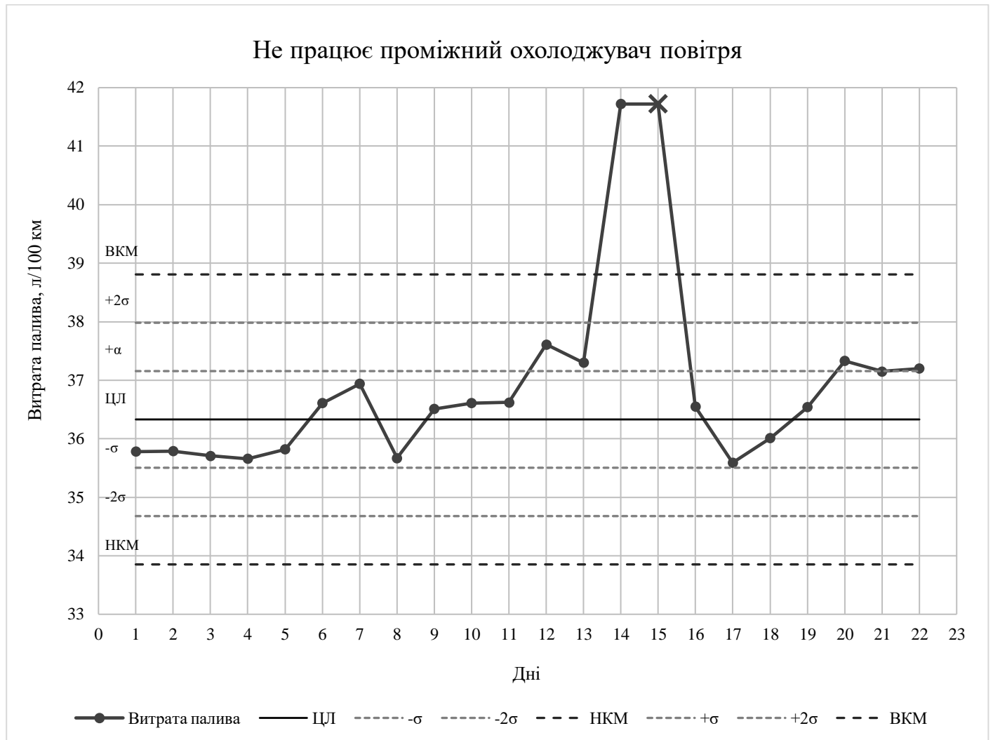
Рисунок 6 – Контрольна карта Шухарта витрати палива в л/100 км при несправності проміжного охолоджувача повітря
