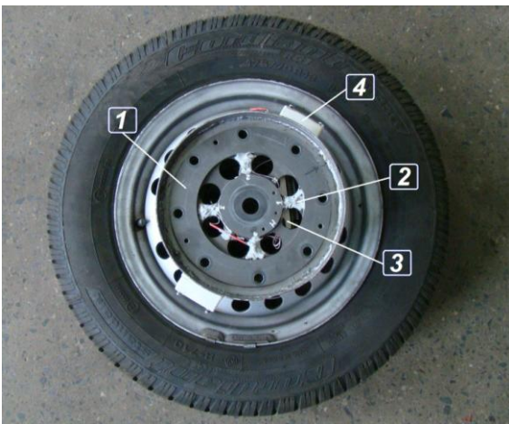
1 – вимірювальне кільце; 2 – тензорезистор з захисним шаром герметика; 3 – підстроювальна плата; 4 – блок живлення
