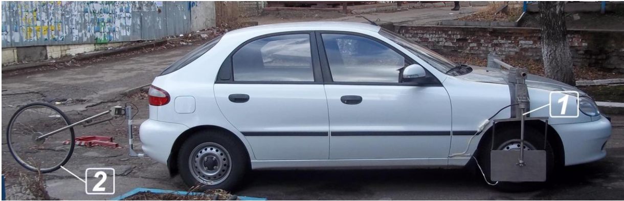
1 – датчик виміру кутів сходження коліс та їх повороту; 2 – «п'яте» колесо вимірювального комплексу
