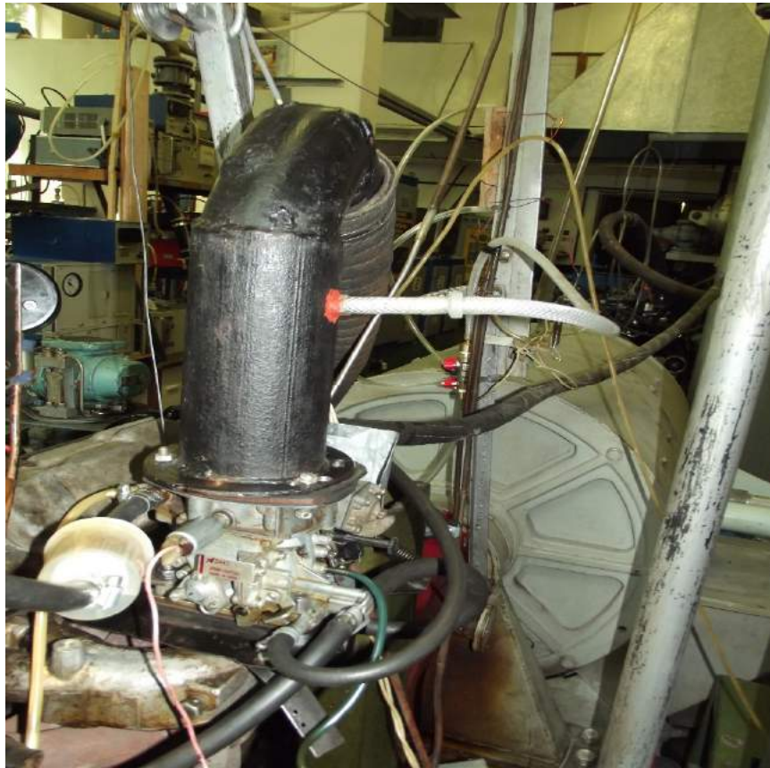
Рисунок 4.2 - Місце подачі водневмісного газу в двигун
