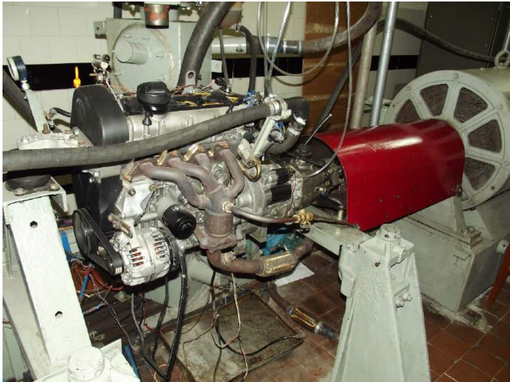
Рисунок 4.3 - Об'єкт експериментальних досліджень - двигун 4Ч 7,65/7,56 із сучасною системою впорскування бензину
