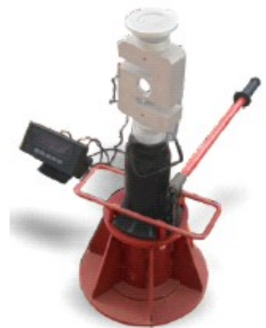
Рисунок 1.2 – Вимірювальне обладнання для статичних штампових випробувань: а) штампове обладнання НТУ; б) прес-штамп ПШ-050 СНВЦ «РОСДОРТЕХ»
