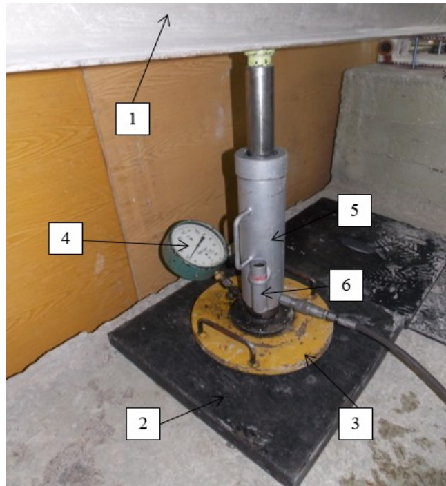
1 – металева балка протизаги; 2 – гумова пластина; 3 – штамп; 4 – еталонна гідравлічна месдоза; 5 – гідроциліндр; 6 – датчик зусилля вимірювальної станції
