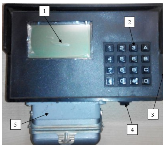
1 – графічний дисплей; 2 – клавіатура; 3 – роз'єм для підключення зовнішнього носія інформації; 4 – перемикач живлення; 5 – системний роз'єм
