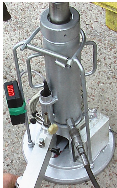
Рисунок 4.2 – Прогиномір зі спеціально встановленою площадкою
