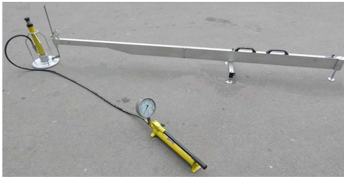
Рисунок 1.2 – Вимірювальне обладнання для статичних штампових випробувань: а) штампове обладнання НТУ; б) прес-штамп ПШ-050 СНВЦ «РОСДОРТЕХ»
