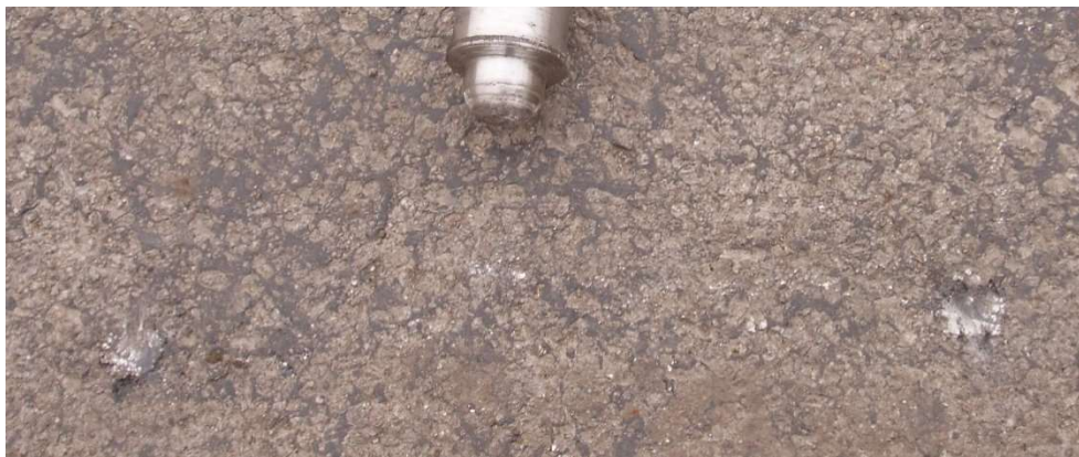
Рисунок 2.23 – Лунки, що утворились на покритті, після серії ударних навантажень індентором R = 55 мм
