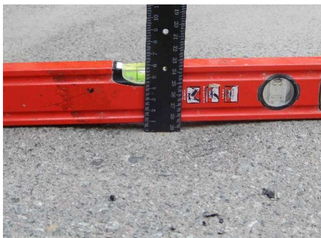
Рисунок 4.14 – Лунка на покритті, що утворюється після серії ударних навантажень
