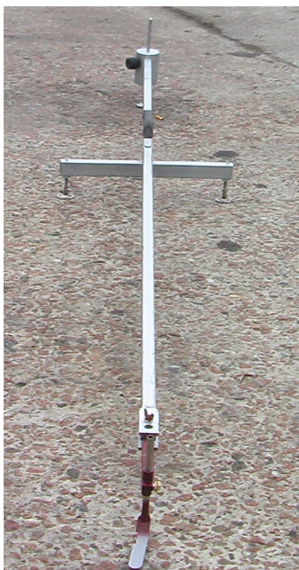
Рисунок 4.2 – Прогиномір зі спеціально встановленою площадкою
