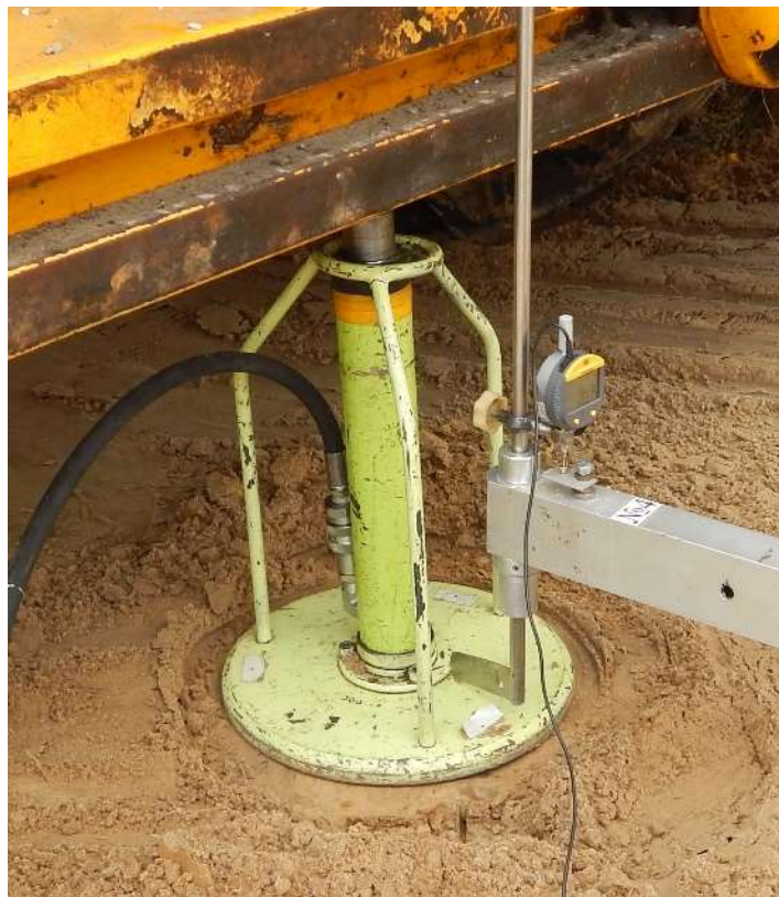
Рисунок 2.6 – Перекос штамп при проведенні випробувань ґрунтової основи
