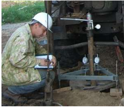
Рисунок 1.5 – Статичні штампові випробування з використанням вимірювального пристрою з двома датчиками переміщень
