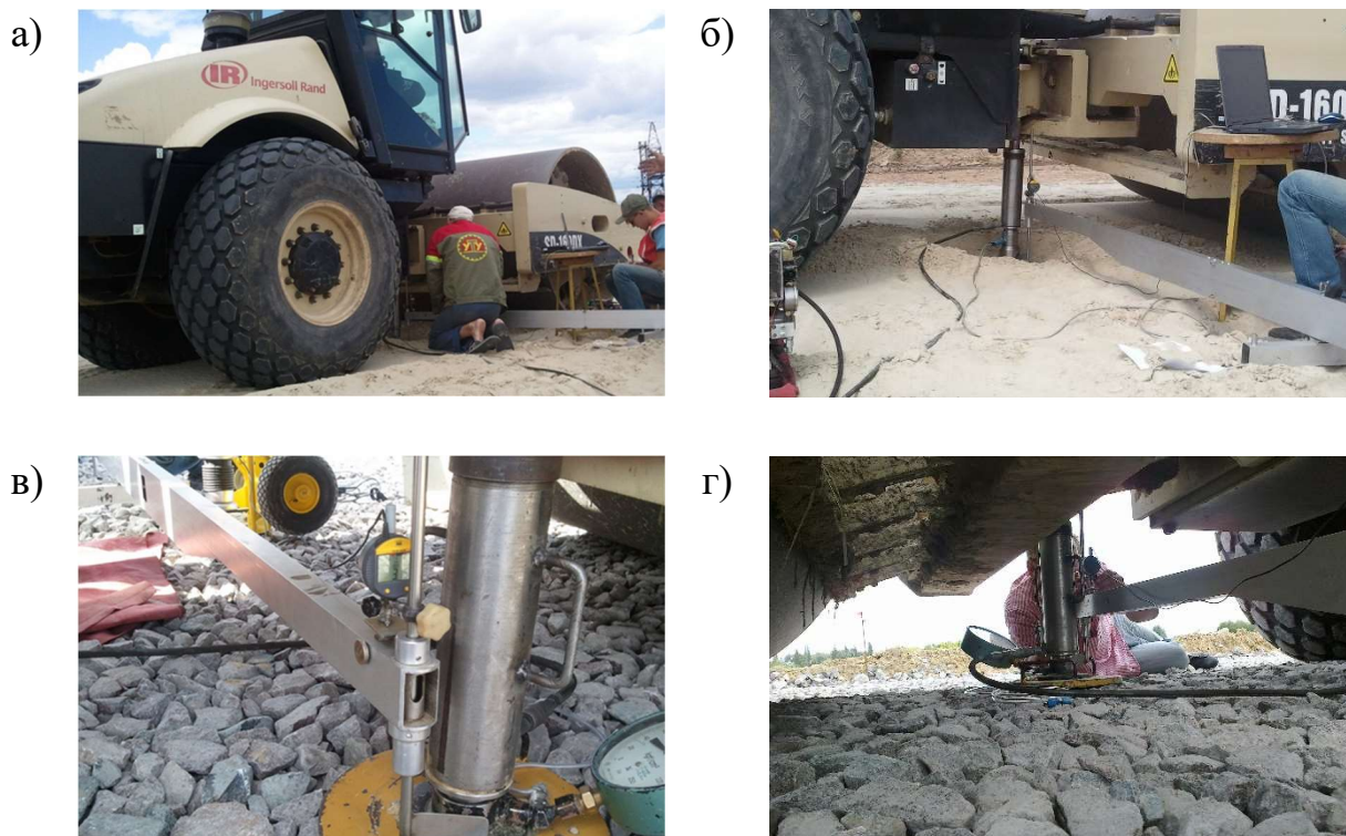
Рисунок 3.23 – Статичні штампіві випробування з використанням вимірювальної станції: а, б) ґрунтової основи; в, г) щебених шарів
