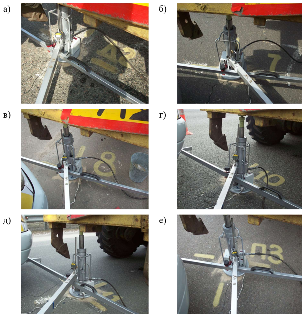
Рисунок 3.25 – Статичні штампіві випробування з використанням вимірювальної станції на дослідних ділянках: а) «Д2»; б) «7»; в) «8+»; г) «10»; д) «11»; е) «ПЗ»
