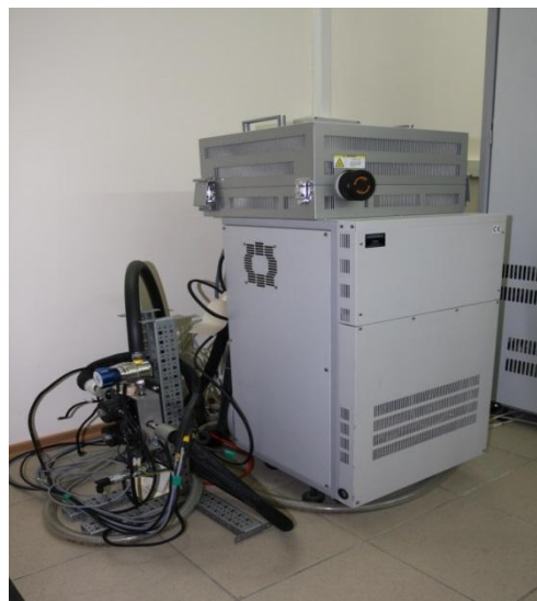
Рисунок 4.7 – Газоаналізуючий комплекс МЕХА-7400ДЕGR
