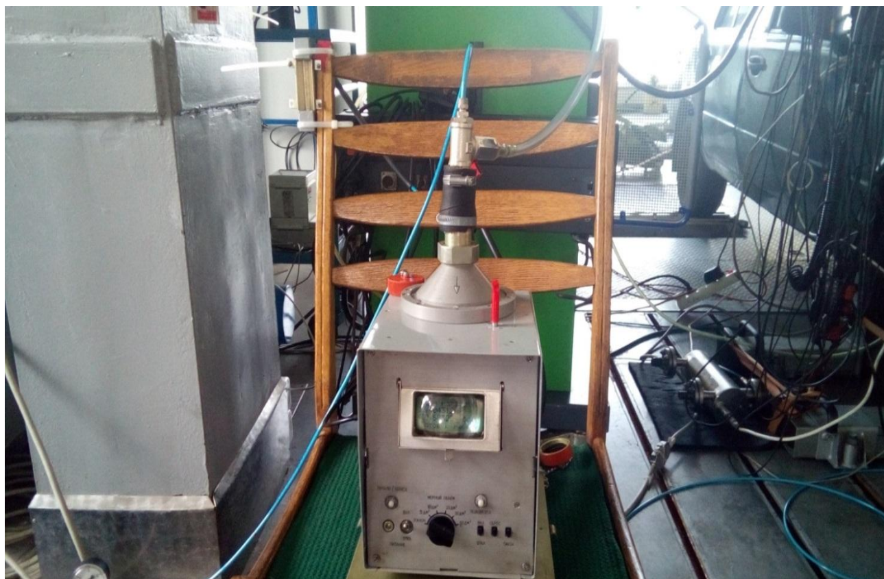
Рисунок 2.8 – Об'ємний лічильник газу еталонний «КАЛІБР»
