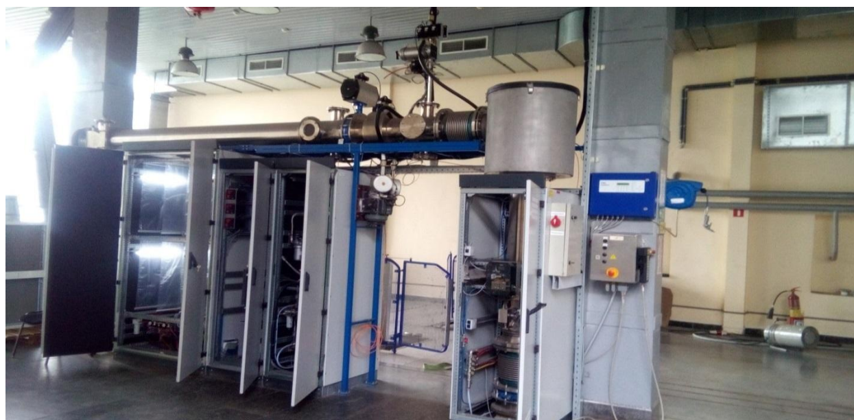
Рисунок 4.6 – Загальний вид CVS (Constant Volume Sampling)
