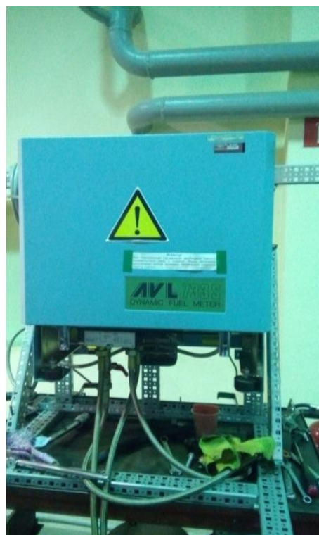
Рисунок 4.4 – Динамічний витратомір маси рідини AVL LIST GmbH типу 733S.18
