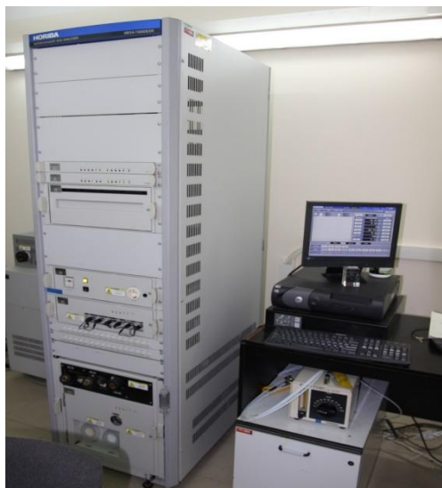
Рисунок 4.7 – Газоаналізуючий комплекс МЕХА-7400ДЕGR
