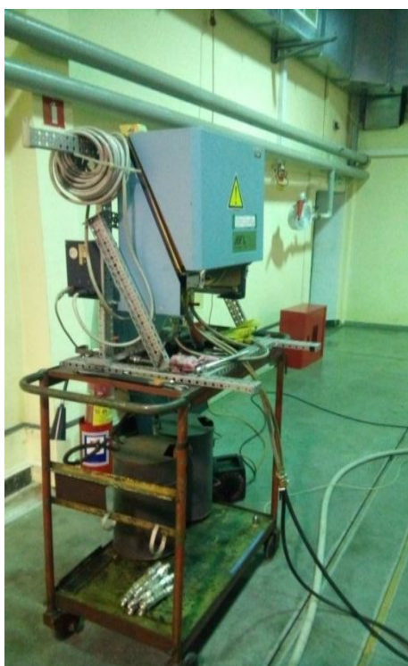
Рисунок 4.4 – Динамічний витратомір маси рідини AVL LIST GmbH типу 733S.18
