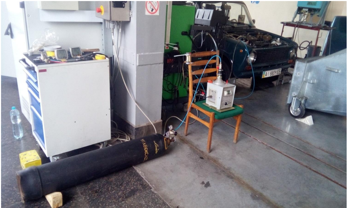
Рисунок 2.7 – Спосіб подачі діоксиду вуглецю в систему живлення двигуна
