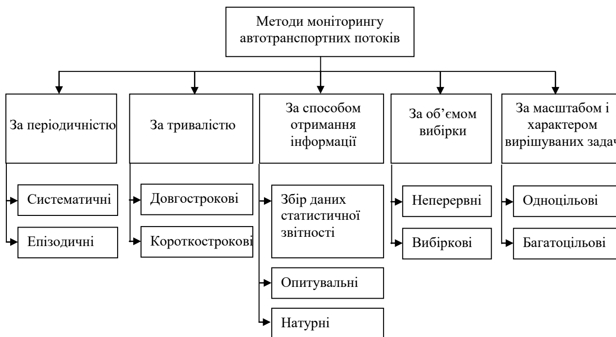
Рисунок 1.1 – Класифікація методів моніторингу автотранспортних потоків [89]
