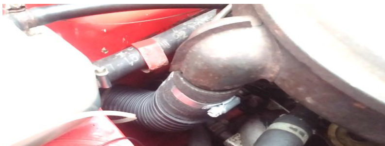
(г) місце кріплення шланга від ТАФП до очисника повітря
