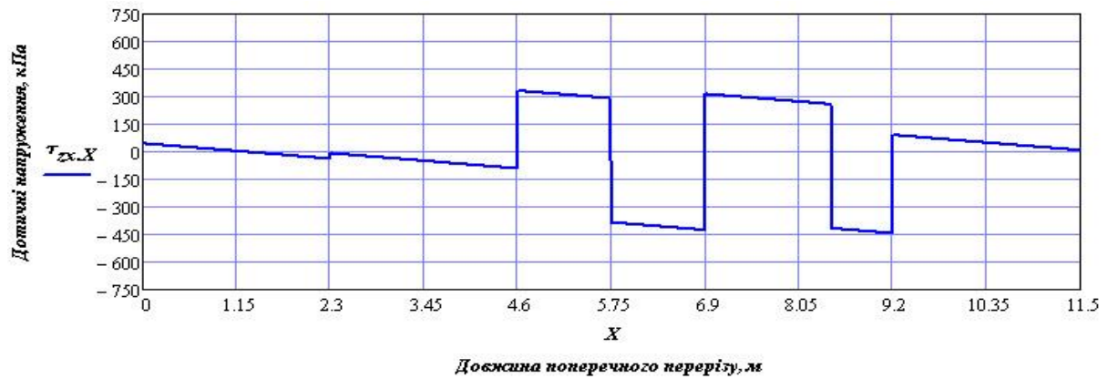
Рисунок 6 – Епюра розподілу дотичних напружень у верхньому поясі армування
