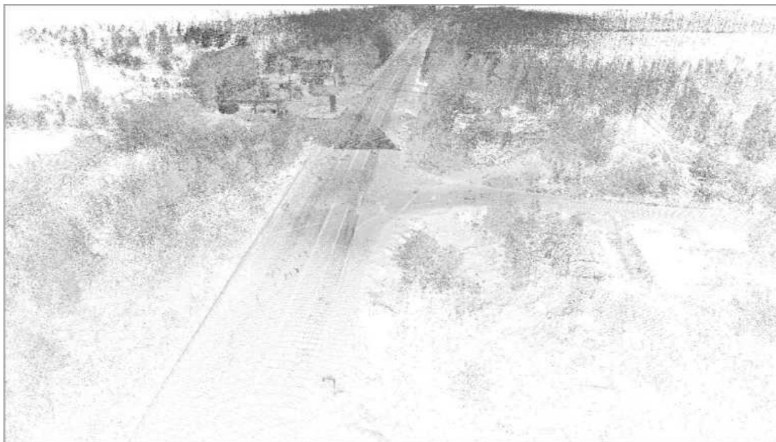
Рисунок 14 – Модель хмари точок, отриманої в результаті лазерного сканування автомобільної дороги
