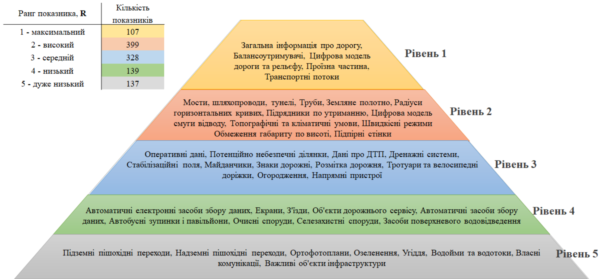
Рисунок 36 – Структурна схема об'єктів паспорта автомобільної дороги державного значення
