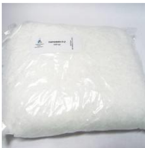
Рисунок 3.4 – Теплоакумулюючий матеріал – парафін – суміш високомолекулярних вуглеводнів C_{18} - C_{35} .
