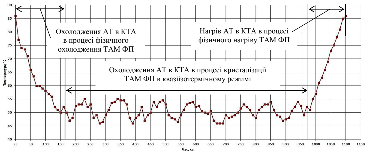
Рисунок 3.19 - Результати дослідження КТА у режимі зберігання накопиченої теплоти від ДГД при температурі оточуючого середовища +20 °C
