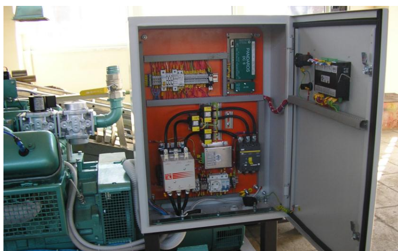
Рисунок 2.10 – Блок керування в ході моторних випробувань дизеля 6Ч13/14
