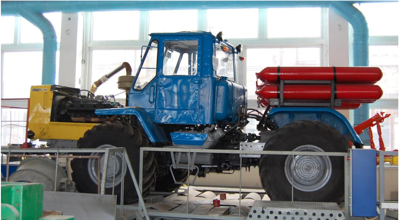
Рисунок 5.20 – Трактор Т150К встановлений на бігових барабанах
