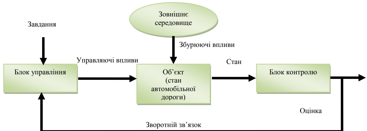
Рисунок 1.2 – Структурна схема системи управління проектом автомобільної дороги
