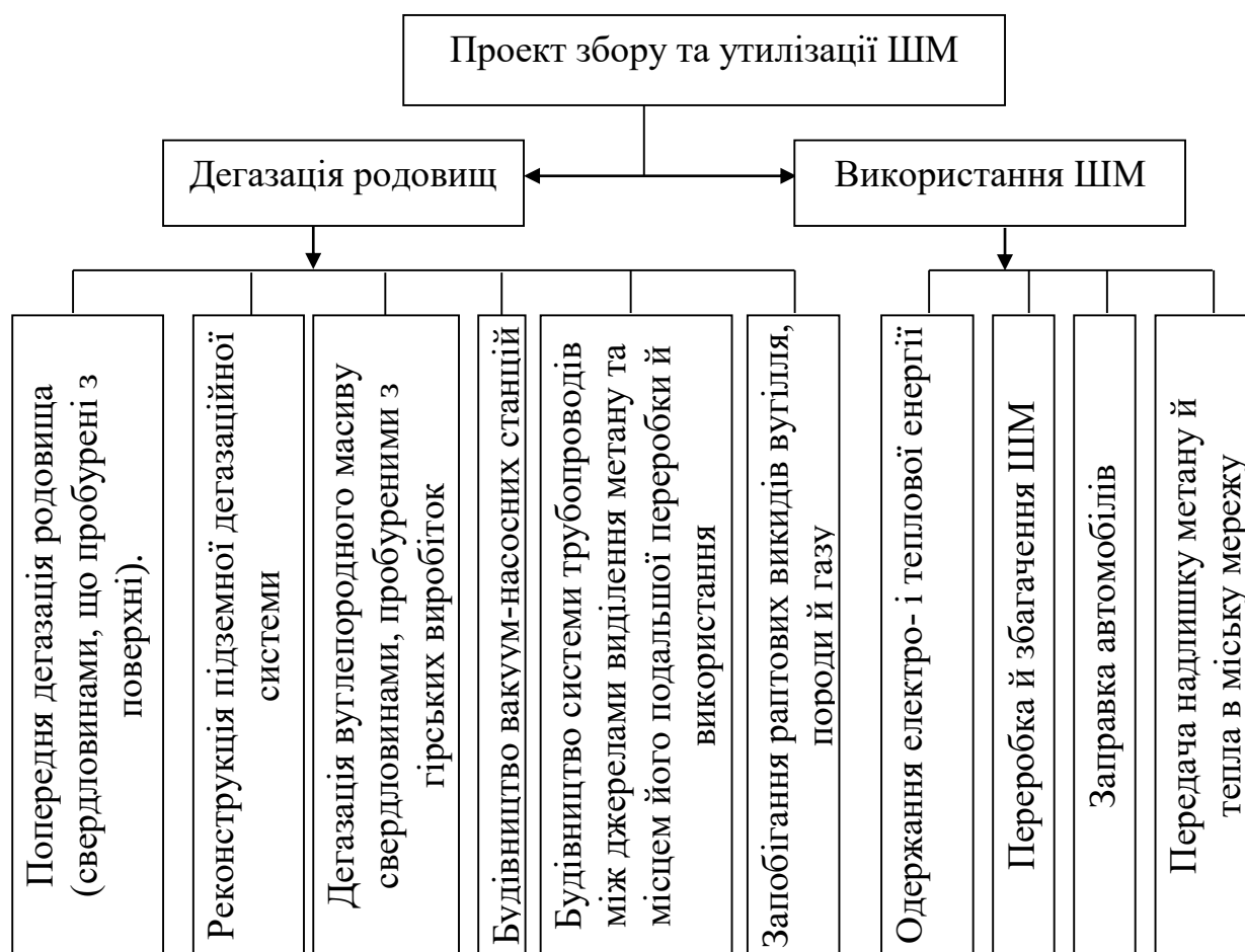
Рисунок 4.1 – Основні етапи проекту видобування, використання та утилізації шахтного метану
