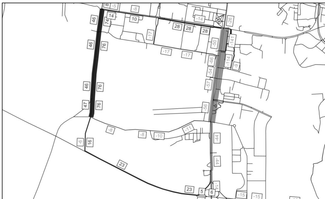
Рисунок 4.7 – Розподіл ТП на ВДМ після впровадження спеціальних смуг на перегонах вулиці (фрагмент): світло сірий, темно сірий – відповідно зменшення та збільшення інтенсивності ТП (авт./год)
