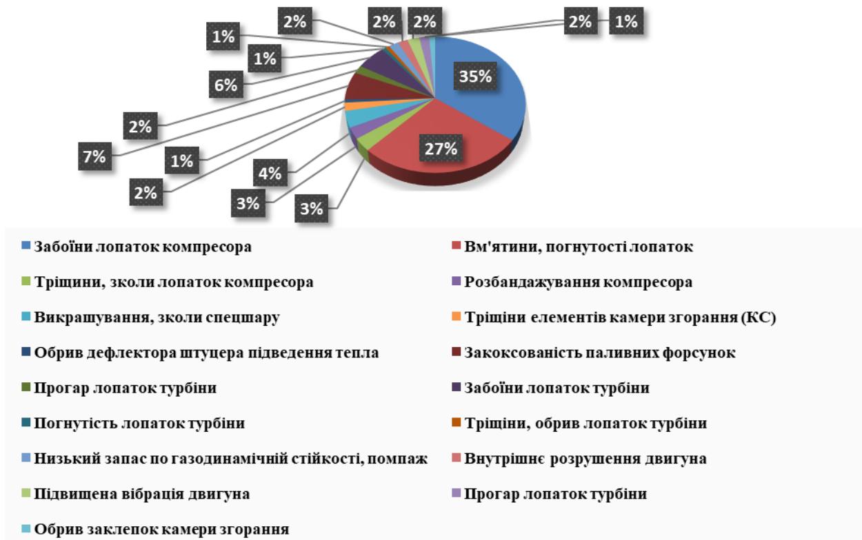
Рисунок 2 – Розподіл видів пошкоджень проточної частини двигунів
