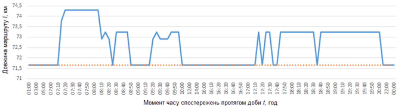
Рисунок 3 – Динаміка перебудови оптимального маршруту доставки вантажів у м. Києві протягом доби в залежності від зміни швидкості ТП на модельних ділянках ВДМ за результатами імітаційного моделювання ( l – довжина перебудованого оптимального маршруту, t – момент часу спостережень протягом доби).
