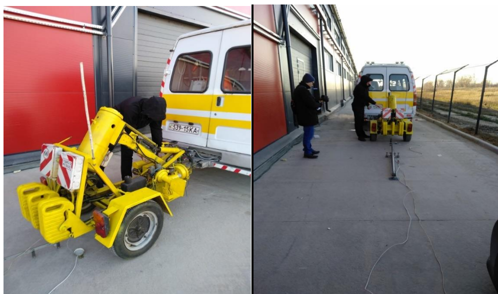
Рисунок Б.7 – Проведення випробувань цементобетонних плит армованих сталлю на ділянці № 1 в точці випробувань № 5
