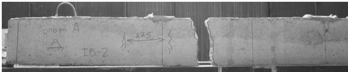
Рисунок 3.13 – Руйнування зразка I Б – 2
