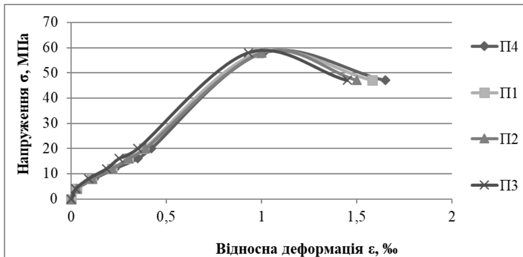
Рисунок 3.23 – Зведена діаграма залежностей «напруження – відносна деформація» для всіх випробуваних призм
