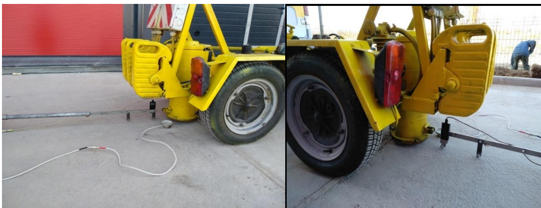
Рисунок Б.8 – Визначення амплітуди коливань та прискорення цементобетонних плит армованих сталюю арматурою на ділянці № 2 в точці випробувань № 5 по краю плити біля деформаційного шва
