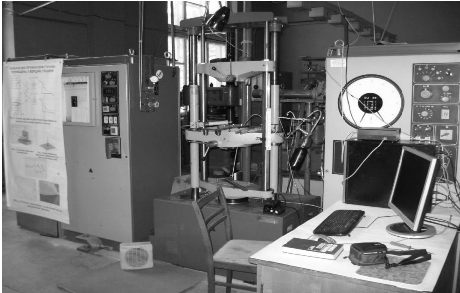
Рисунок 3.1 – Загальний вигляд експериментальної установки для визначення втомної міцності базальтопластикової арматури
