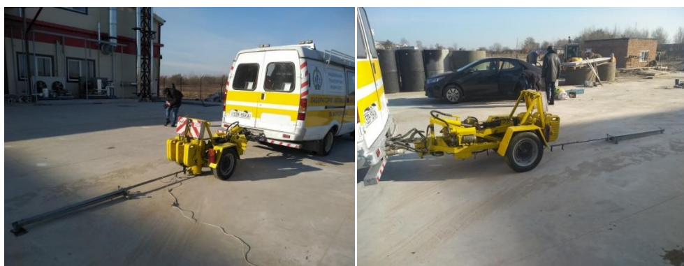
Рисунок Б.4 – Вигляд обладнання НТУ для визначення модуля пружності та затування коливань на поверхні покриття із армованих плит
