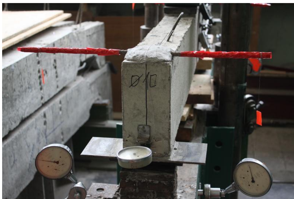
Рисунок В.2– Приклад кріплення прогиноміра Аістова до зразка
