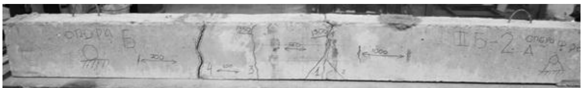
Рисунок 3.14 – Руйнування зразка II Б – 2
