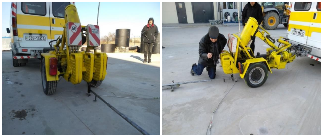
Рисунок Б.6 – Визначення характеристик жорсткості цементобетонних плит армованих неметалевою арматурою на ділянці № 2 в точці випробувань № 3 по краю плити
