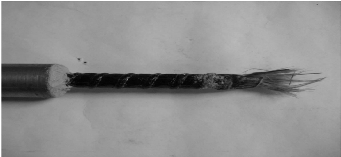
Рисунок 3.3 – Зразок стержня базальтопластикової арматури після руйнування
