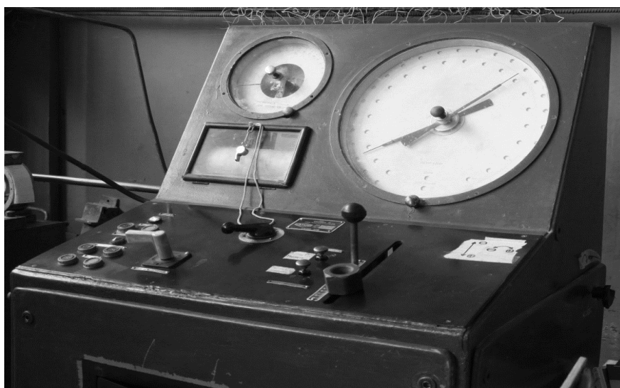
Рисунок 3.18 – Пульт управління універсальної гідравлічної випробувальної машини МУП-50
