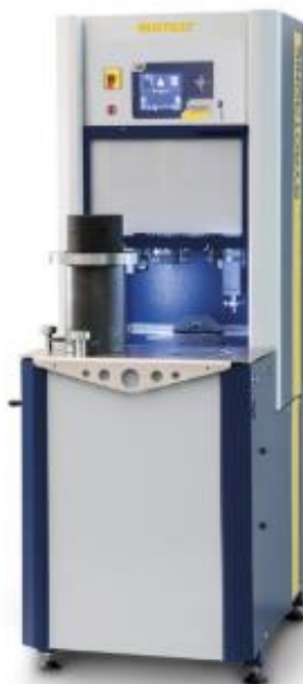
Рисунок 3.14 – Гіраторний ущільнювач B041 ENGyrotronic - Supergrave Gyratory Compactor
