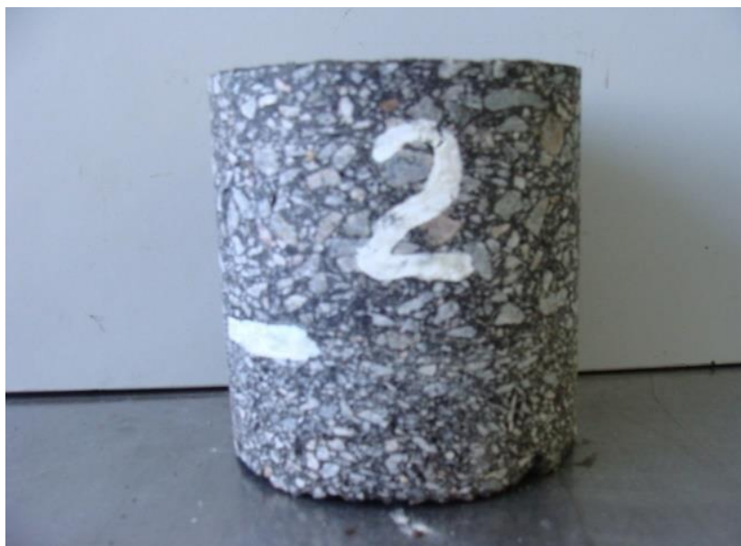
Рисунок 4.7 – Загальний вигляд керну № 2, відібраного з дорожнього одягу автомобільної дороги М-01, км 103+250
