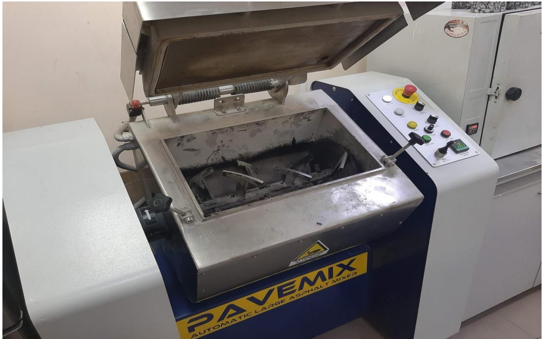
Рисунок 3.1 – Лабораторний змішувач для приготування асфальтобетонних сумішей
