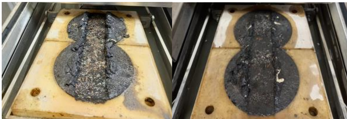
Рисунок 3.19 – Загальний вигляд зразків, виготовлених із асфальтобетону зі строком служби 20 років після випробування на колієстійкість
