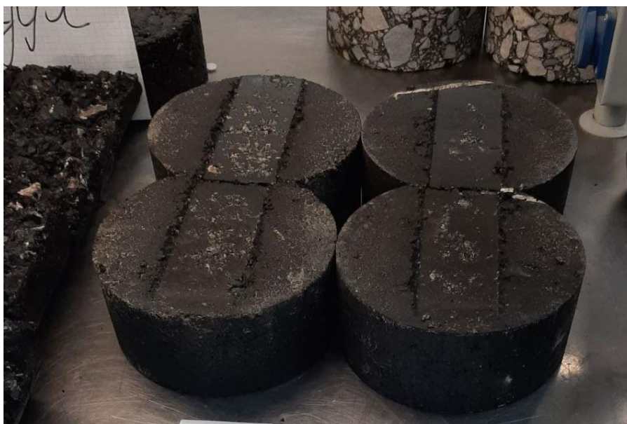
Рисунок 3.20 – Загальний вигляд зразків, виготовлених із асфальтобетону зі строком служби 10 років після випробування на колієстійкість
