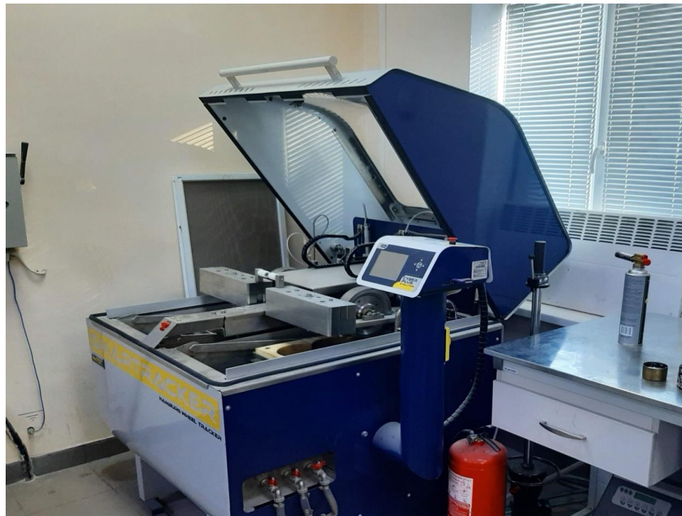
Рисунок 3.16 – Установка для випробувань прокатування колеса за гамбурзьким методом
