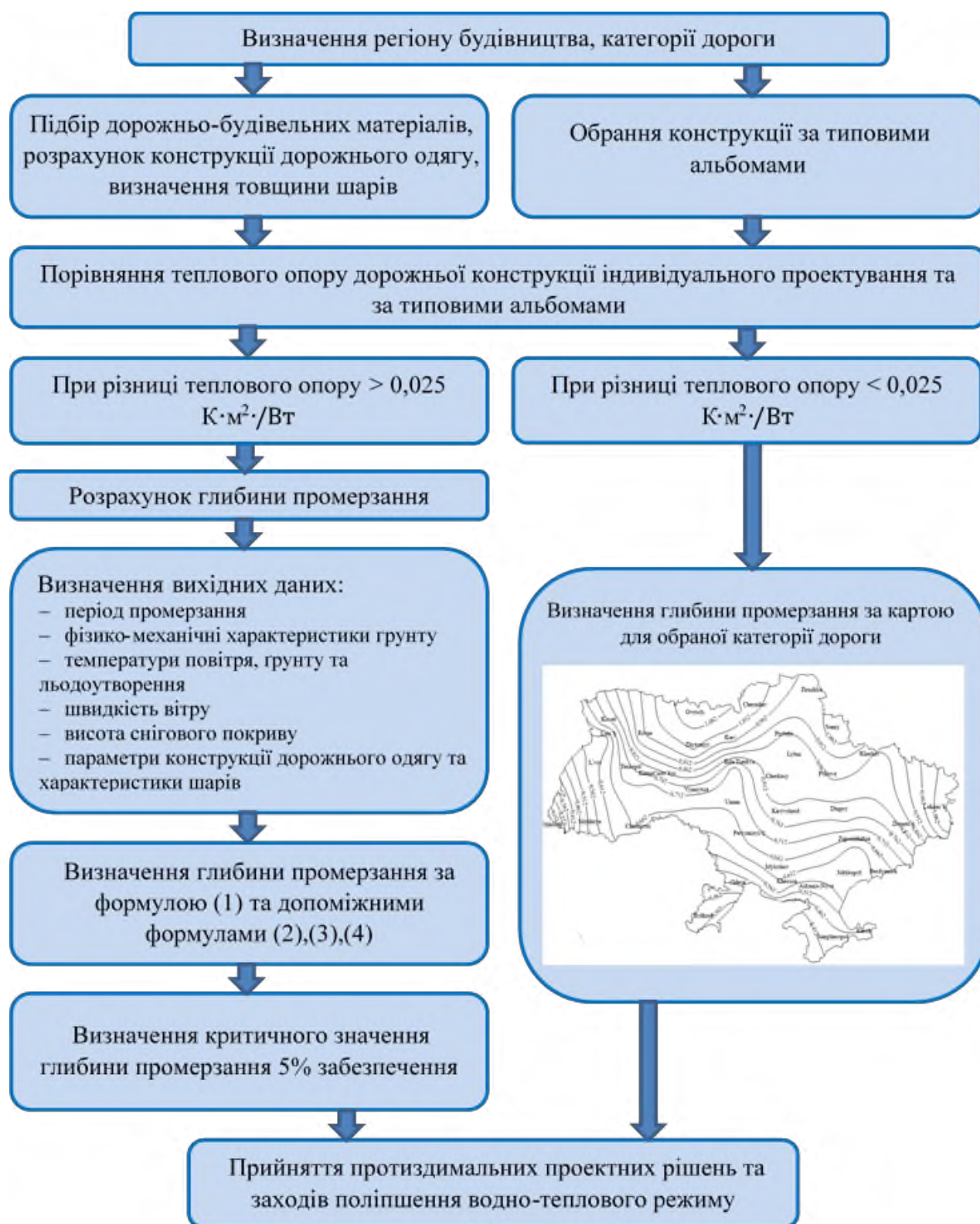
Рисунок 4.4 – Схема прийняття проектних рішень щодо підбору параметрів споруд для регулювання волого-теплового режиму
