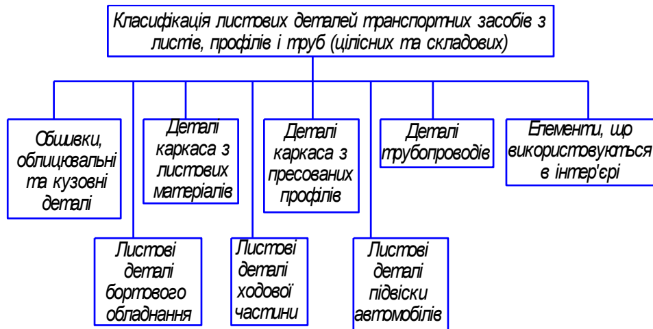
Рисунок 3.1 – Загальна класифікація листових деталей транспортних засобів за конструктивними ознаками
