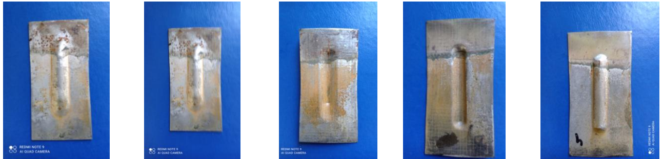
Рисунок 4.19 – Зразки деформованих пластин після випробування на корозійну стійкість
