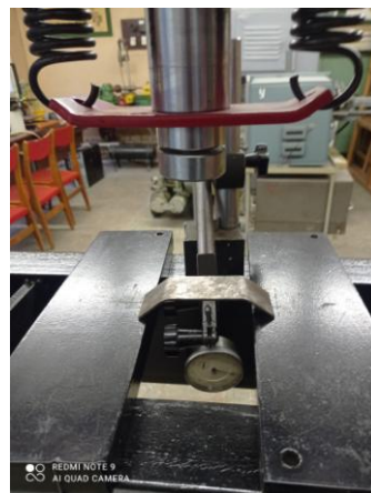
Рисунок 4.2 – Оснащення та вимірвальна апаратура для вимірювання стріли прогину в центрі випробуваної пластини
