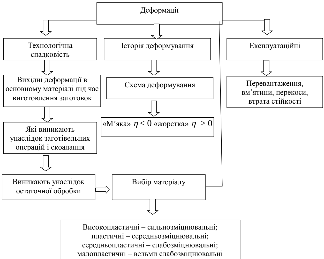
Рисунок 3.4 – Вплив пластичної деформації на ресурс листових деталей
