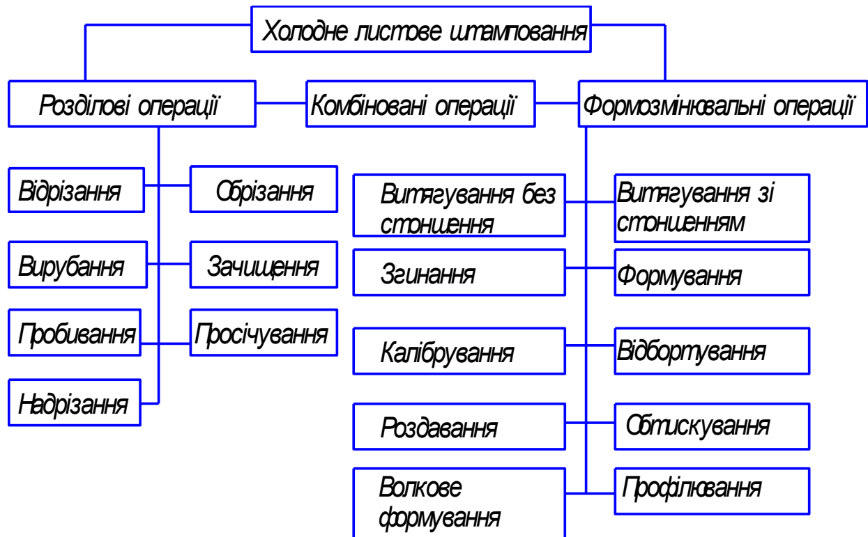
Рисунок 3.2 – Класифікація основних операцій холодного листового штампування під час виробництва та ремонту
