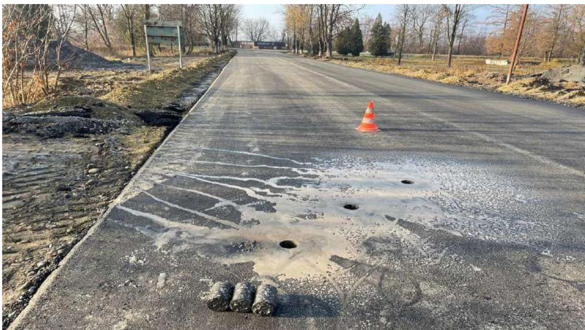
Рисунок 4.12 – Відібрані зразки-керни на під'їзній автомобільній дорозі до прохідної 1-го блоку ДТЕК Бурштинської
