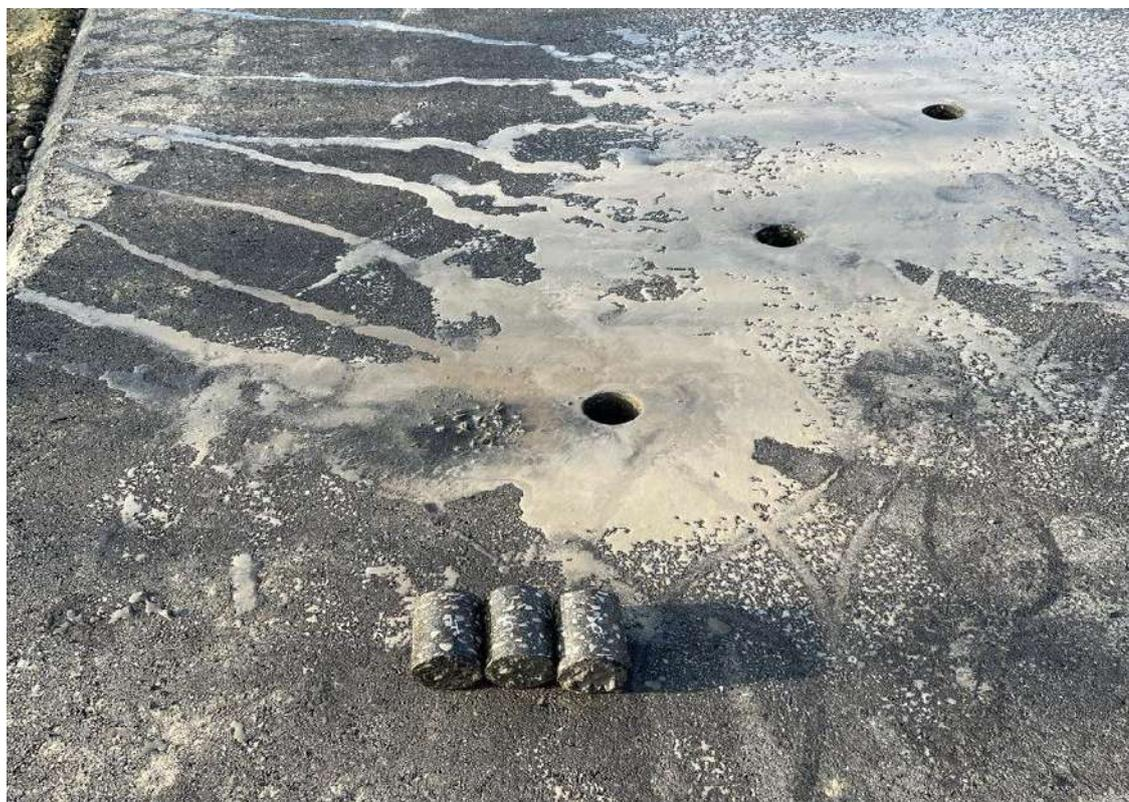
Рисунок 4.10 – Відібрані зразки-керни на під’їзній автомобільній дорозі до прохідної 1-го блоку ДТЕК Бурштинської ТЕС
