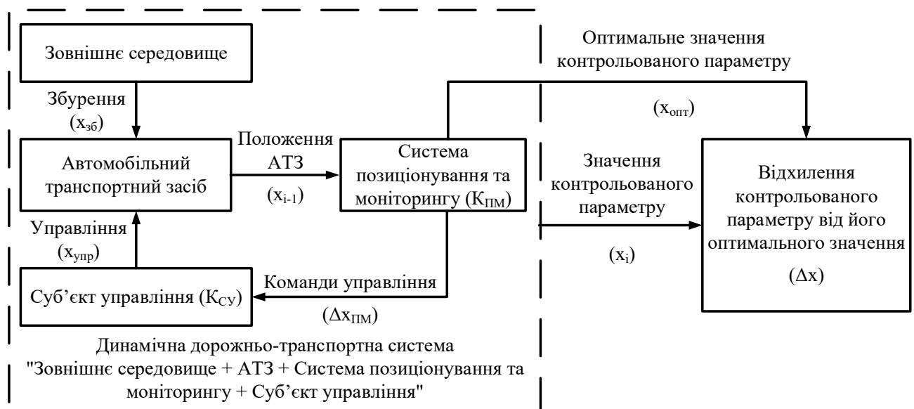
Рисунок 4.2 – Схема управління параметром повздовжньої відстані між АТЗ
