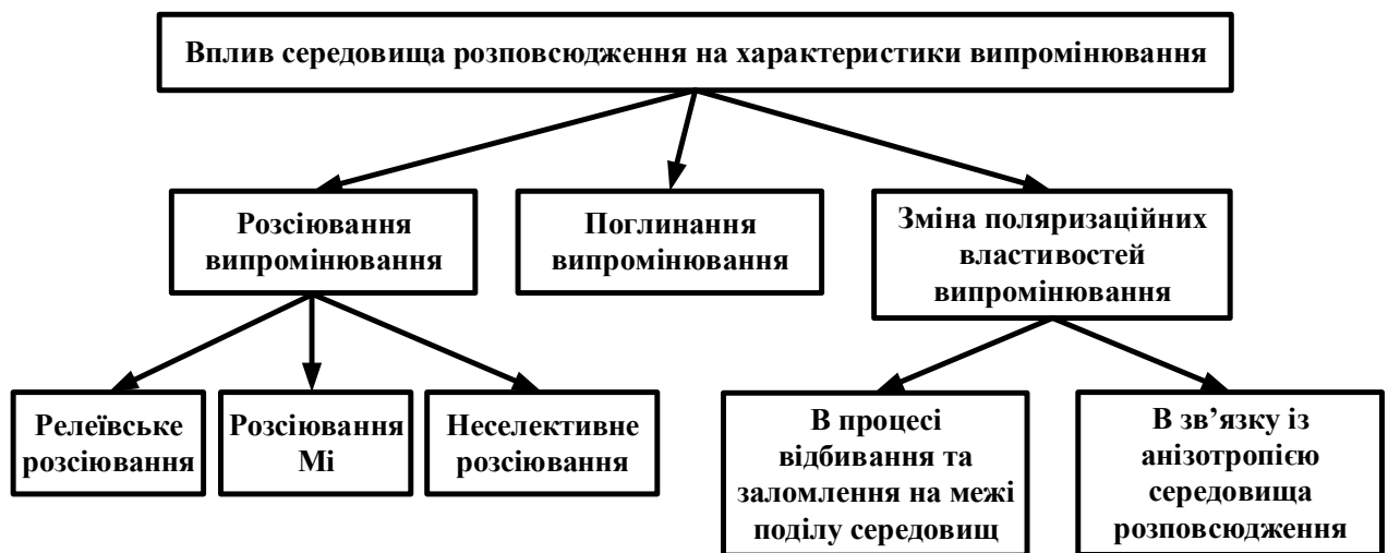
Рисунок 2.16 – Схема впливу середовища розповсюдження на характеристики випромінювання
