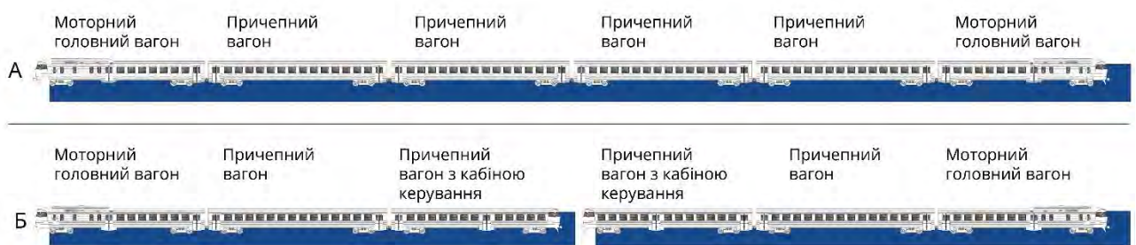
Рисунок 8 – Компонування состава дизель-поїздів ДР1А: А) заводська, Б) після модернізації
