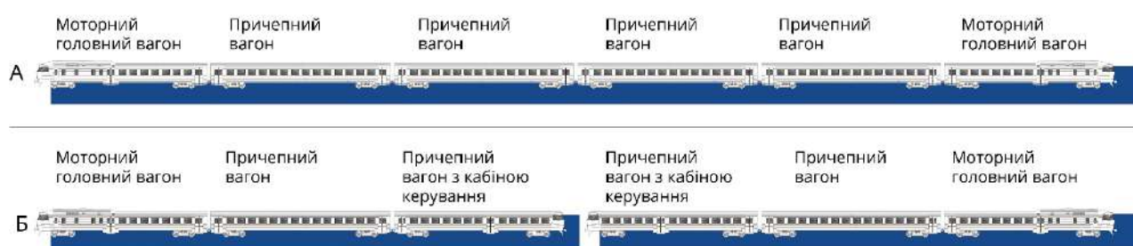
Рисунок 5.18 – Компонування дизель-поїздів ДР1А:
