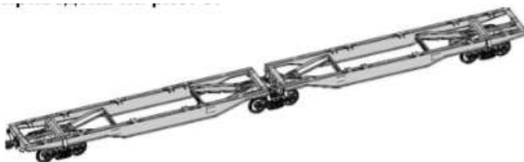
Рисунок 5.10. Зчленований вагон-платформа, що зчленовані вузлом SAC-1 компанії Cardwell Westinghouse (США)
