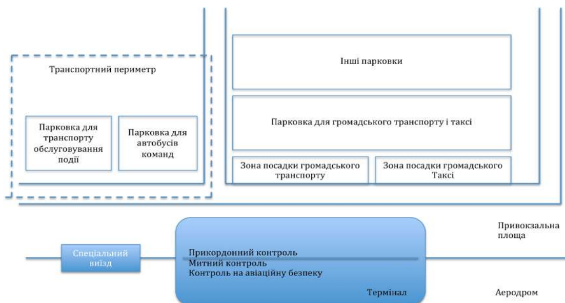
Рисунок 5.25 – Принципова схема організації привокзальної площі при обслуговуванні масового заходу
