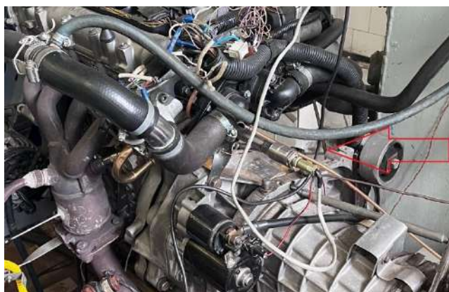
Рисунок 3.8 – Високотемпературний тензометричний перетворювач надлишкового тиску МИДА–ДИ–12П–081 встановлений на двигуні
