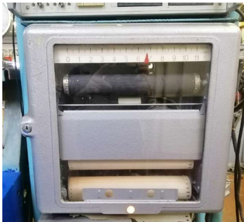
Рисунок 3.5 – Пристрій виводу показників температури з термопары ТХА-410
