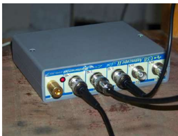
Рисунок 3.9 – Аналого-цифровий перетворювача USB Autoscope II
