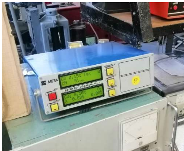
Рисунок 3.4 – Багатокомпонентний газоаналізатор «Автотест-02 CO-CO2- CH-O2- λ -Т»
