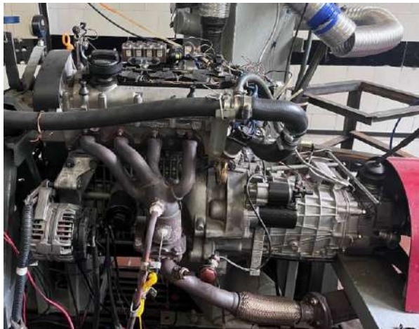
Рисунок 3.1 – Об’єкт дослідження двигун з іскровим запалюванням VW BBU
