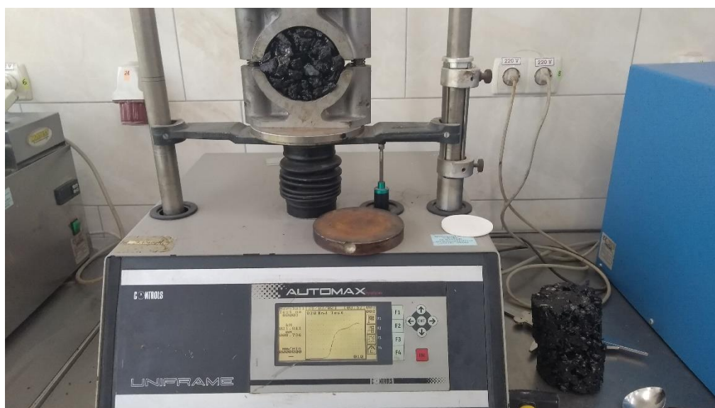
Рисунок 3.15 – Загальний вид випробування зразків ДАБ-16 за методом Маршала
