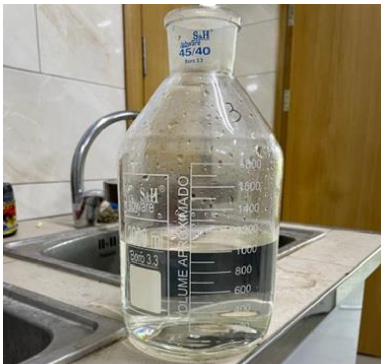
Рисунок 3.25 – Спеціальна мірна колба для вимірювання точного об'єму воду для випробування
