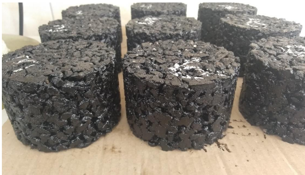
Рисунок 3.13 – Загальний вид зразків ДАБ-8 з різним вмістом бітуму підготовлених до випробувань
