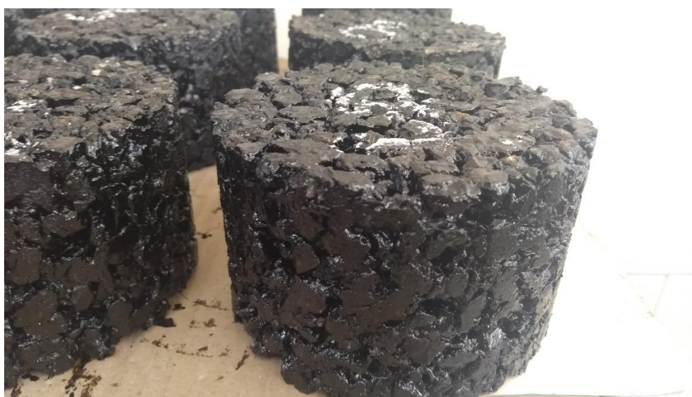
Рисунок 3.14 – Загальний вид структури зразків ДАБ-8
