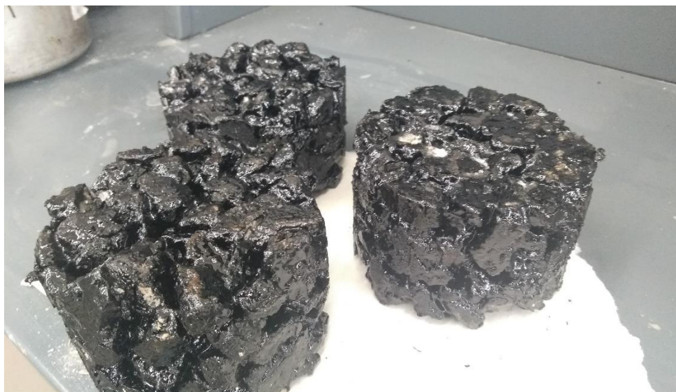
Рисунок 3.9 – Загальний вид зразків ДАБ-16 після виформовування
