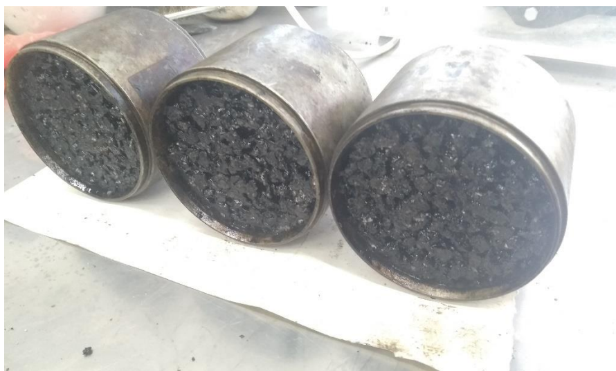
Рисунок 3.8 – Заформовані зразки ДАБ-8 в формах при охолодженні з певним вмістом бітуму
