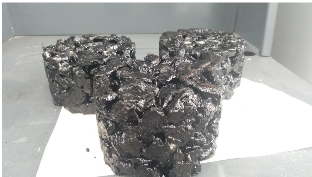
Рисунок 3.10 – Загальний вид структури зразків ДАБ-16
