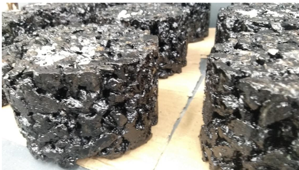
Рисунок 3.12 – Загальний вид структури зразків ДАБ-11
