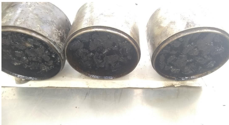
Рисунок 3.7 – Заформовані зразки ДАБ-16 в формах при охолодженні з певним вмістом бітуму
