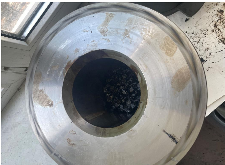
Рисунок 3.23 – Заформований зразок методом гіраторного ущільнення в спеціальній формі при остиганні перед випробуванням
