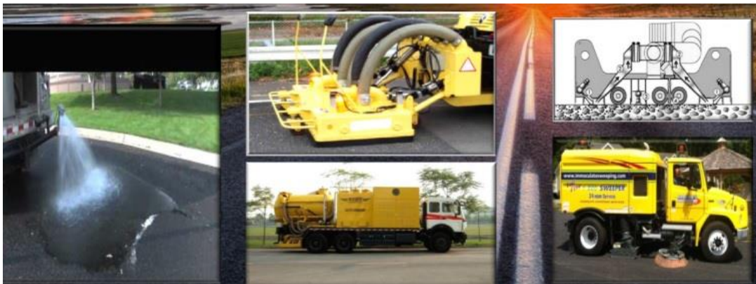
Рисунок 1.13 Варіанти вирішення проблеми з кольматацією пор. Зліва-направо: промивання під тиском; вакуумні очисники високого тиску; спеціальними машинами для очищення.
