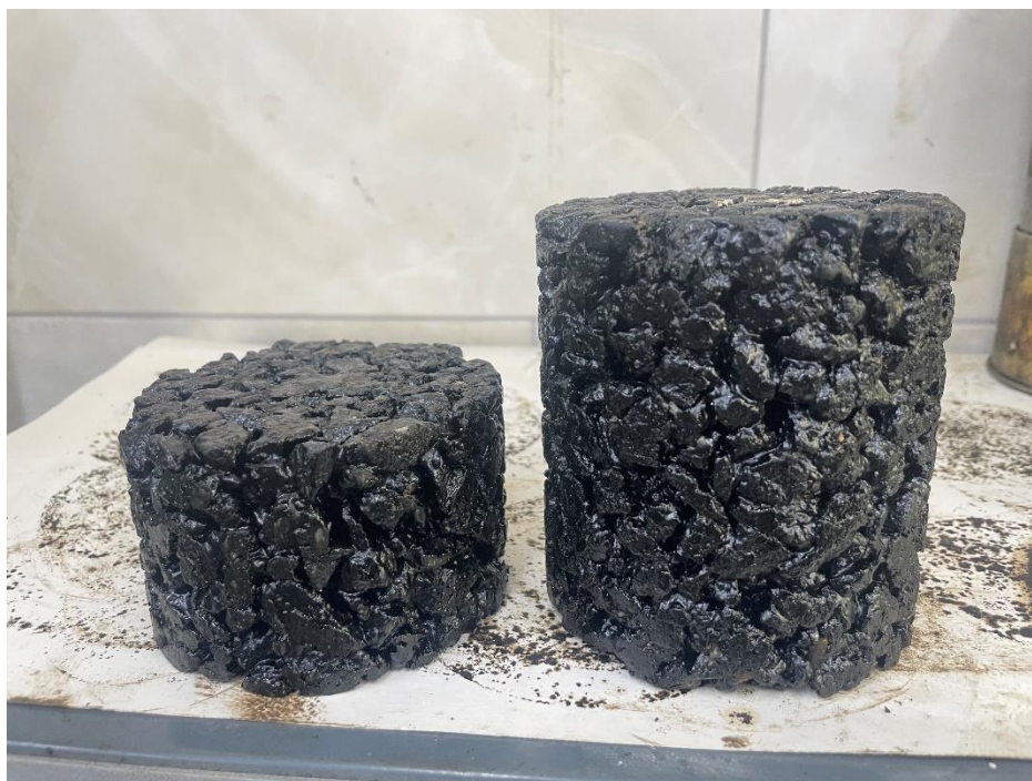
Рисунок 3.24 – Загальний вид структури зразків заформованих на гіраторному та ударному ущільнювачі для випробування на проникність
