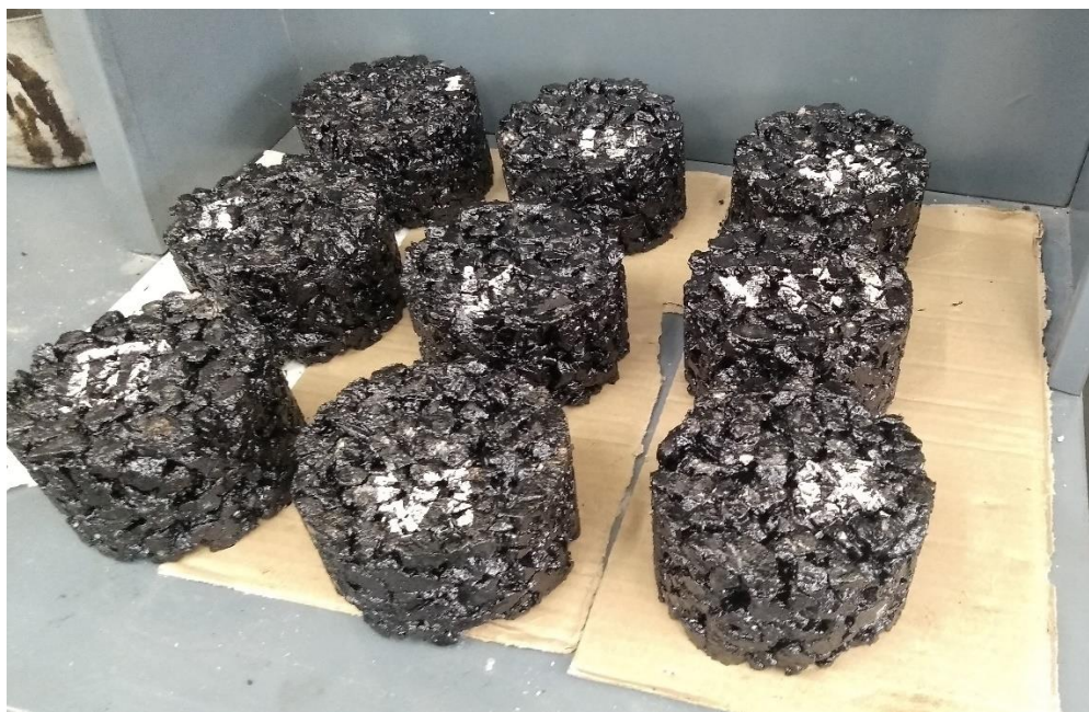
Рисунок 3.11 – Загальний вид зразків ДАБ-11 з різним вмістом бітуму підготовлених до випробувань
