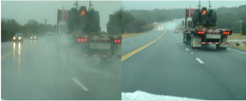
Рисунок 1.12 Перевага видимості від зменшення бризг та водяного пилу
