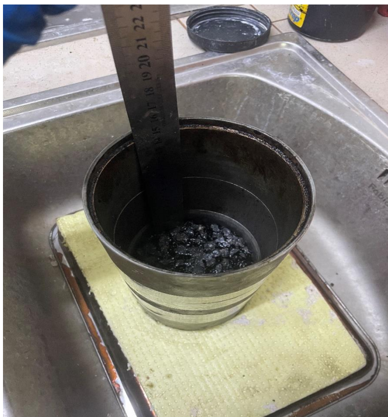
Рисунок 3.26 – Зразок виготовлений за Маршалом в формі перед випробуванням
